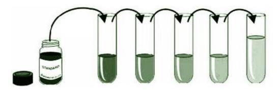
135 pmol/L 90 pmol/L 60 pmol/L 30 pmol/L 15 pmol/L 7.5 pmol/L
